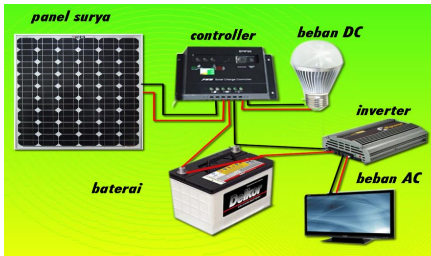
Gambar 2.2. Contoh skema PLTS photovoltaic
